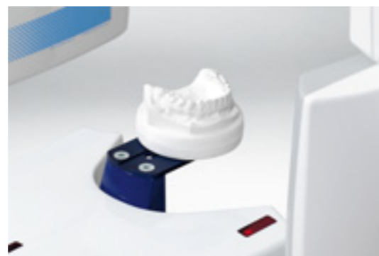
Skenování sádrového odlitku na digitální model
