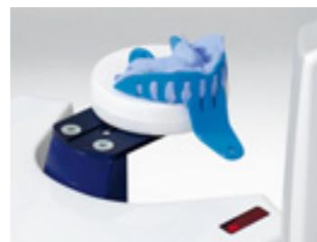
Snímek otisku pořízený přístrojem Planmeca ProMax® 3D
